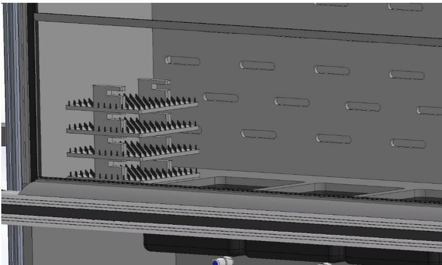
3. 启动自动处理后，机械手将托盘从装载站取出，并将其从一个槽输送到下一个槽，从而实现自动并行处理。
